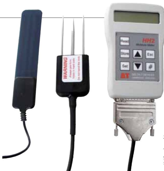
Fot. 4. Sondy pojemnościowe z czytnikiem (sensor umieszczony pośrodku mierzy także EC i temperaturę gleby)
