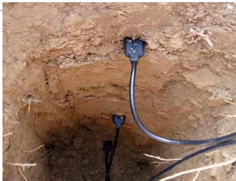
Fot. 8. Sondy pojemnościowe umieszczone w glebie
