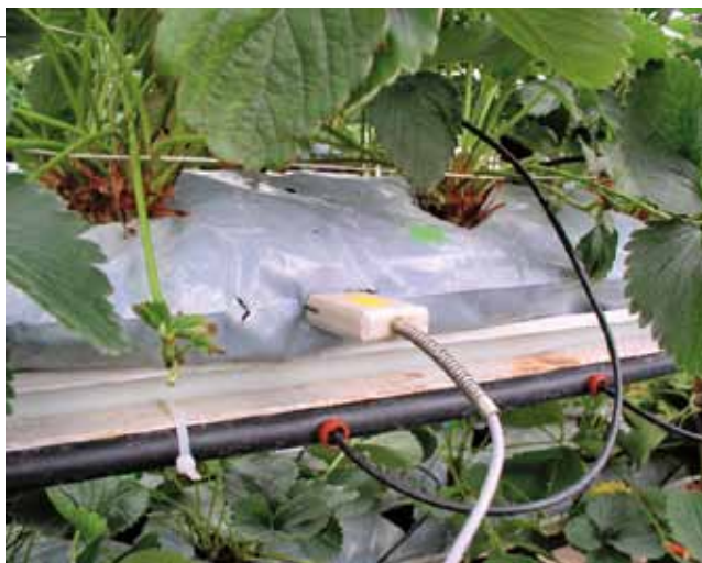
Fot. 5. Sonda pojemnościowa umieszczona w podłożu (bezglębowa uprawa truskawki)
