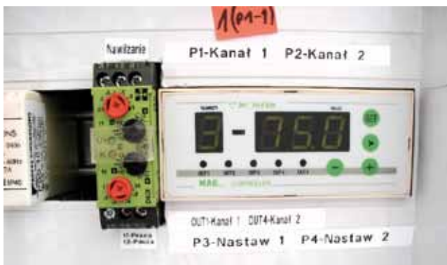
Fot. 6. Moduł sterujący nawadnianiem na podstawie odczytów z sond pojemnościowych
