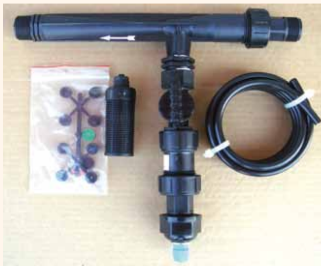
Fot. 2. Inżektor wraz ze smokiem i przewodem ssawnym oraz restryktorami (elementy w woreczku foliowym)
