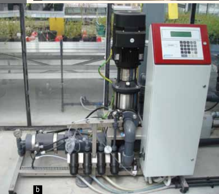
Fot. 7. Mikser nawozowy ze zbiornikiem mieszającym (a), z komorą mieszania (b)
