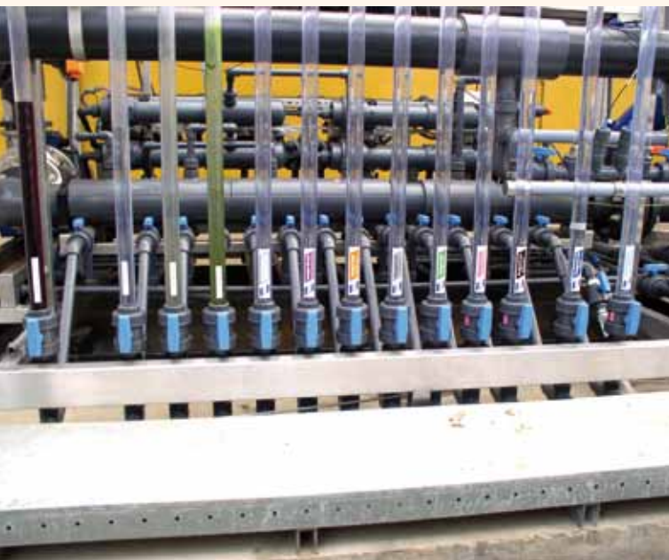
Fot. 8. Dozownik pobierający 13 różnych roztworów nawozowych
